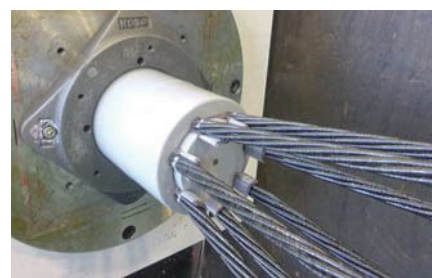
写真-4 試験後の固定定着具の状況
