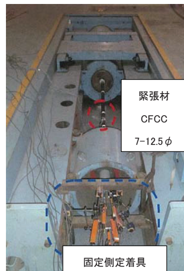
写真-5 疲労試験状況
