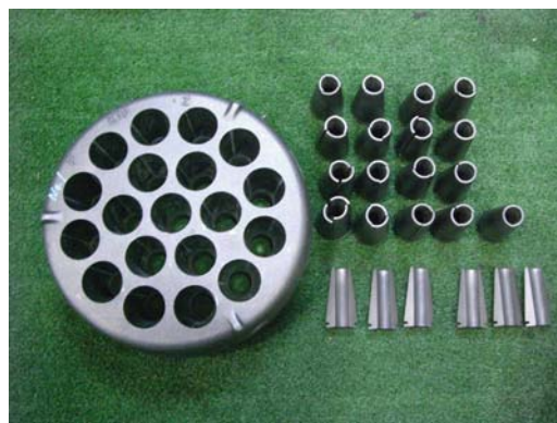
写真-3 試験後に解体した定着具
