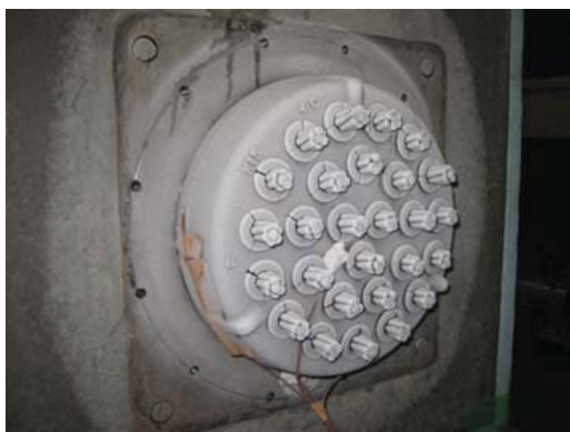
写真-2 試験後の定着具
