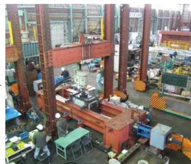
写真-7 フレッシング疲労試験の状況
