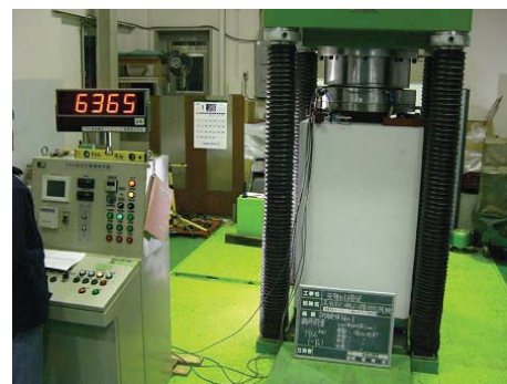
写真-6 定着具とコンクリートを組み合わせた性能試験
