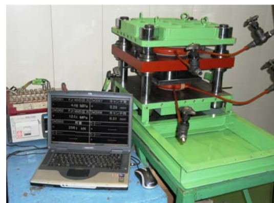
写真-3 一定荷重载荷試験状況
