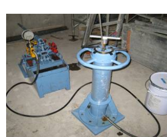
写真-8 セメント系注入材用機材
